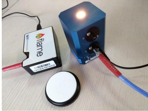
图 11 ISP 积分球反射颜色测量系统实物图
