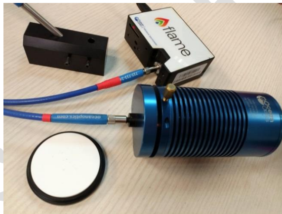
图 10 QR 探头反射颜色测量系统实物图
