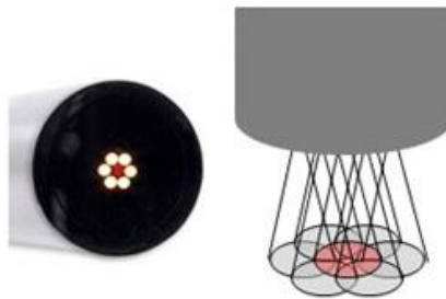
图 7 反射探头端口示意图
