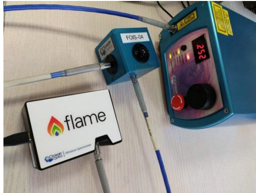
图 4 激光波长检测实验图
